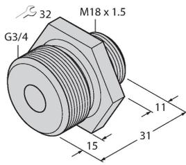
Ввинчиваемый переходник для датчиков контроля потока серии F(T)CST для ввинчивания в тройник или сварочную втулку; технологическое соединение G3/4", наружная резьба
