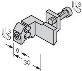
Монтажный кронштейн для установки датчиков магнитного поля на профильные цилиндры с внешней направляющей типа "ласточкин хвост"; диаметр цилиндра: 32...200 мм; материал: Алюминий
