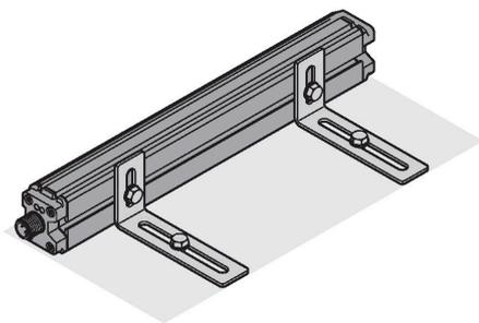
La gamme importante d'accessoires de montage permet beaucoup de possibilités de montage. Grâce au principe de mesure qui se base sur un couplage de circuit oscillant, le détecteur de positionnement linéaire n'est pas affecté par des éléments de fer remagnétisés ou par d'autres champs parasites.
