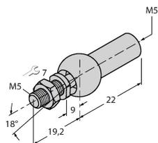
articulation axiale pour transmetteur de position guidé ; matériau : acier inoxydable
