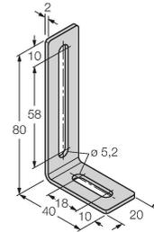
Équerre de montage et clavette rainurée pour détecteurs de positionnement linéaire LI-Q25L ; matériau : acier inoxydable ; 2 pièces par sac
