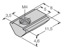
Clavette avec filetage M4 pour profil détecteur arrière pour le détecteur de positionnement linéaire LI-Q25L ; matériau : A galvanisé ; 10 pcs par sac
