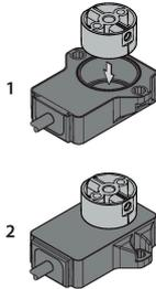
Deux types de montage différents sont disponibles. Le transmetteur de position peut être placé au-dessus du boîtier du détecteur. Il peut également être monté de telle façon à recouvrir complètement le boîtier du détecteur.
