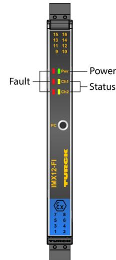
El contador de pulsos/transductor de frecuencia IMX12-FI01-2SF-2I-CPR/24 VCC/CC está equipado con circuitos de entrada intrínsecamente seguros y transmite señales de frecuencia de hasta 20 000 Hz del área con riesgo de explosión al área sin riesgo de explosión, de modo que las señales se aíslan galvánicamente. Además, las señales de entrada se pueden supervisar por deslizamiento. Los dispositivos son adecuados para el funcionamiento en la zona 2.
