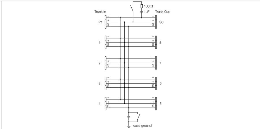
El módulo de distribución Ex de ocho canales, tipo JRBS-40-8C/EX, está diseñado para sistemas de bus de campo conforme a la IEC 61158-2, o sea, tanto para el bus de campo FOUNDATION™ como para el PROFIBUS-PA.
