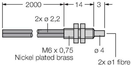
Fibra óptica de material sintético, modo de detección: sensor fotoeléctrico, casquillo roscado M3 x 0,75 mm, conductor confeccionable sin pieza terminal, funda exterior de polietileno, temperatura ambiente de -30 °C...+70 °C
