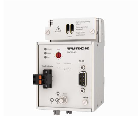
El convertidor de medios de fibra óptica FOC11... convierte las señales RS485, p. ej., de PROFIBUS-DP o Modbus RTU de los cables de cobre en señales ópticas y viceversa. Por lo tanto, las señales de bus se pueden transmitir desde la zona segura hasta la Zona 1 en largas distancias de una manera intrínsecamente segura sin potencial ni interferencia.
